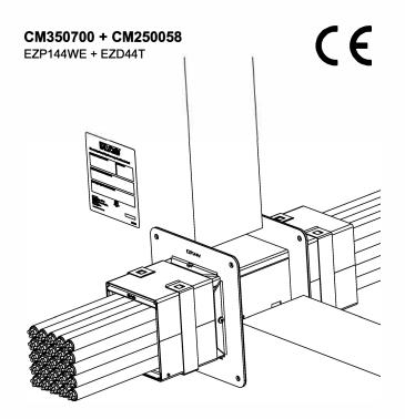
Opening dimensions : Ø152 - Ø155 mm or 118 x 105mm
