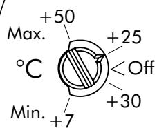
外部传感器用于限制楼层内的温度。如果选择最小限值，只要温度降低至极限值，恒温调节器接通继电器的电源。入宫测得的外部温度高于极限值，断开设有最大极限值的继电器。
